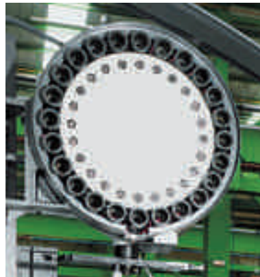
Drum type ATC Trommel Werkzeugwechsler Magasin changeur d'outils type tambour
